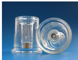
Spritzgewicht: 35 g Kunststoff: Polyamid 6.6 Einlegeform, Umspritzter Gewindeinsatz
